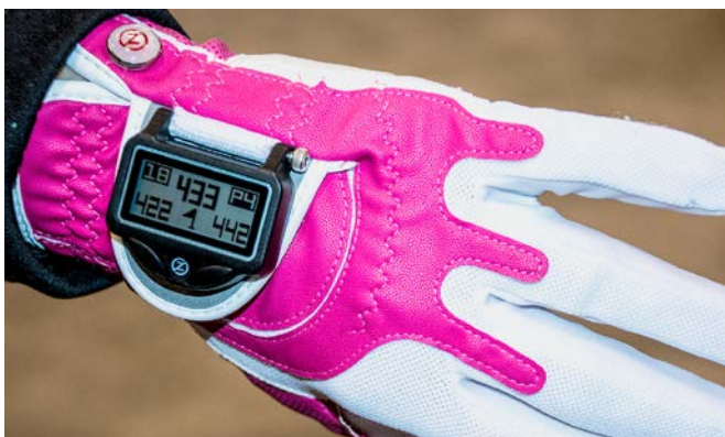
GPS-Technologie im Handschuh – kommuniziert wird mit einer Smartphone-App.
