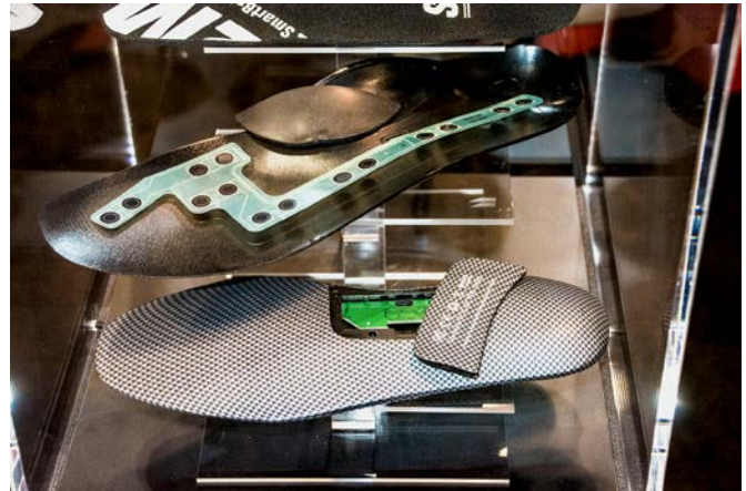
Mittels spezieller Einlegesohlen wird die Kraft- und Druckmessung drahtlos übertragen und anschließend analysiert.
